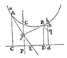
ordinata bd, ei occurrat Bb Horizonti parallela in b, atque Bq tangenti Ag parallela in q; atque sit AC ordinata positione data, & BD ordinata mobilis; & sint CD = z, DB = y, longitudo curvae AB = v, crassitudo in B = x, pondus funiculi AB = p, CE : CA : AE :: 1 : n : m, atque a pondus datum aequale tensioni fili in A.
