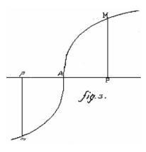
§. 27. Quaeritur nunc quomodo ex curva hac data inveniri et construi possit curva quaesita coordinatis orthogonalibus x et y contenta; seu quomodo ex p et Q datis inveniri et construi possint x et y. Id quod sequenti modo efficietur. Cum sit
