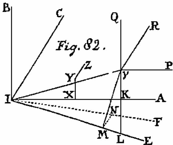
Sit  $I$  centrum inertiae corporis et rectae  $IA, IB, IC$  eius tres axes principales (Fig. 82), quorum respectu momenta inertiae sint  $Maa, Mbb, Mcc$ . Iam a quacunque vi corpus sollicitetur, notetur eius transitus per planum binis axis principalibus interceptum  $AIB$ , qui fit in puncto  $V$ , ab  $I$  distante intervalllo  $IV = h$  existente angulo  $AVI = \delta$ ; ipsa
