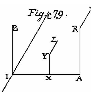
applicanda. Hinc solutionem problematis ita complectemur: cum axe gyrationis proposito  $IA$  eiusmodi binae directrices  $IB$  et  $IC$  coniungatur (Fig. 79), ut constitutis pro quovis corporis elemento  $dM$  coordinatis illis parallelis  $IX = x$ ,  $XY = y$  et  $YZ = z$  positaque  $XZ = \sqrt{(yy + zz)} = r$  fiat  $\int xzdM = 0$ .
