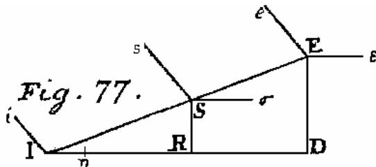
rectae  $ID$  sit parallelia. Ad certum punctum fixum  $D$  statuatur planum ad rectam  $ID$  normale, ac ducta recta  $ISE$  loco vis  $Ss$  in punctis  $I$  et  $E$  substitui poterunt vires  $Ii$  et  $Ee$  ipsis parallelae, ut sit
