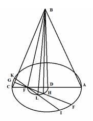
In cono recto triangula non per axem ducta, quorum bases in eodem puncto se intersecant, habent perpendiculares ad bases e vertice ductas, In peripheria circuli cuius diameter est recta inter centrum basis coniae & punctum intersectionis interiecta.
