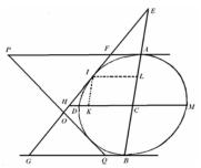
conicarum ut EC ad CA ita CA ad CL, & ita divisim EC-CA ad CA-CL, seu EA ad AL, & composite EA ad EA+AL seu EL ut EC ad EC+CA seu EB; ideoque, ob similitudmem triangulorum EAF, ELI, ECH, EBG, AF ad LI ut CH ad BG. Est itidem, ex natura sectionum conicarum, LI seu CK ad CD ut CD ad CH; atque ideo ex aequo perturbate AF ad CH ut CD ad BG. Q.E.D.
